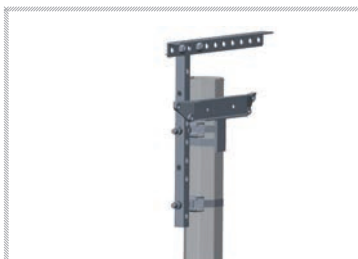
On metallic pole with an existing alpac (alu alloy) bracket, positioning on pole side with two flanges Sur poteau métallique, implantation sur le côté en présence d'une semelle alpax, avec deux brides
